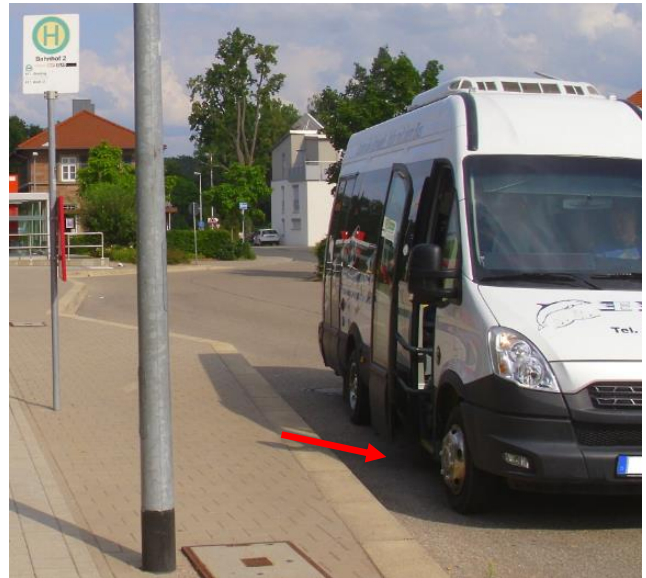
Abb.38: Hilpoltstein Bahnhof – Die Außenschwenktüren des Kleinbusses können das 20 cm-Hochbord beim Öffnen nicht überstreichen. Der Bus muss daher in relativ großem Abstand zum Bord halten.
