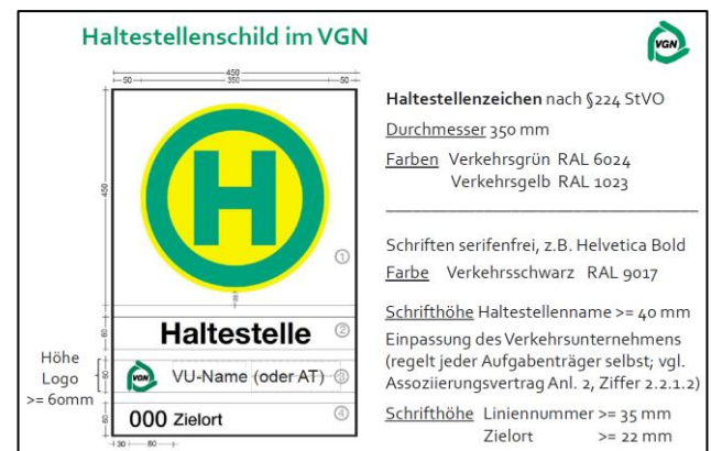
Abb. 39: Aufbau eines Haltestellenschildes nach VGN-Standard
