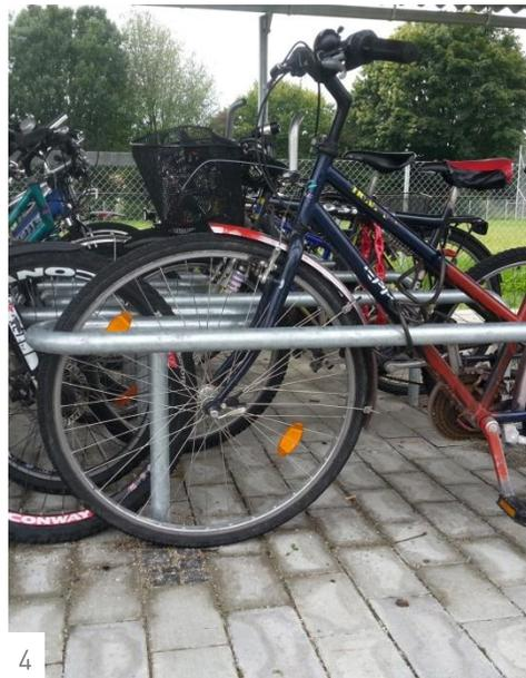
Einstellbügel sind an Bahnhöfen, Umstiegspunkten zum ÖPNV, Schulen und bei Arbeitgebern zu finden und werden oft für mehrere Stunden, bzw. tageweise genutzt. Radfahrer schätzen an diesen Bügel, dass ein sicherer Anschluss von Rahmen und Vorder- oder Hinterrad möglich ist und die Einstellbügel für viele Radtypen geeignet sind.
