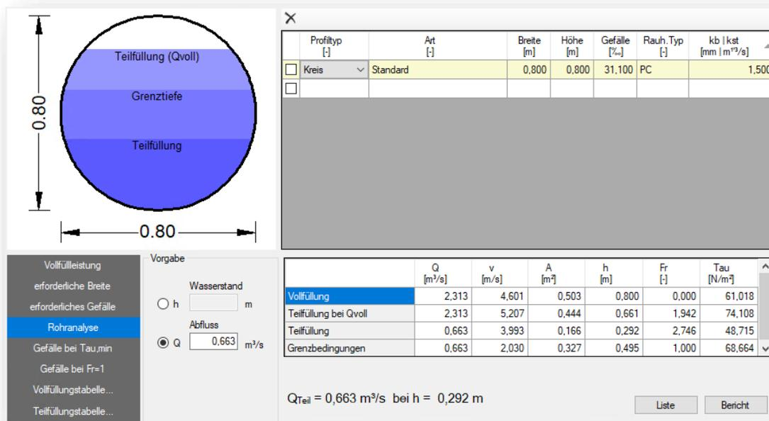
Abbildung 2 Rohrhydraulik der verrohrten Engstelle (via Hydraulik-Expert 3.3)
