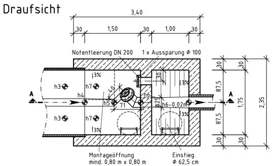
Bei linksdrehenden Wirbelventilen wird das Bauwerk spiegelsymmetrisch zur Achse A-A angelegt.
