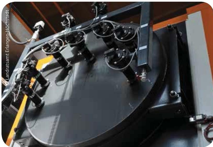
**Wärmetauscher mit pneumatischer Abreinigung
