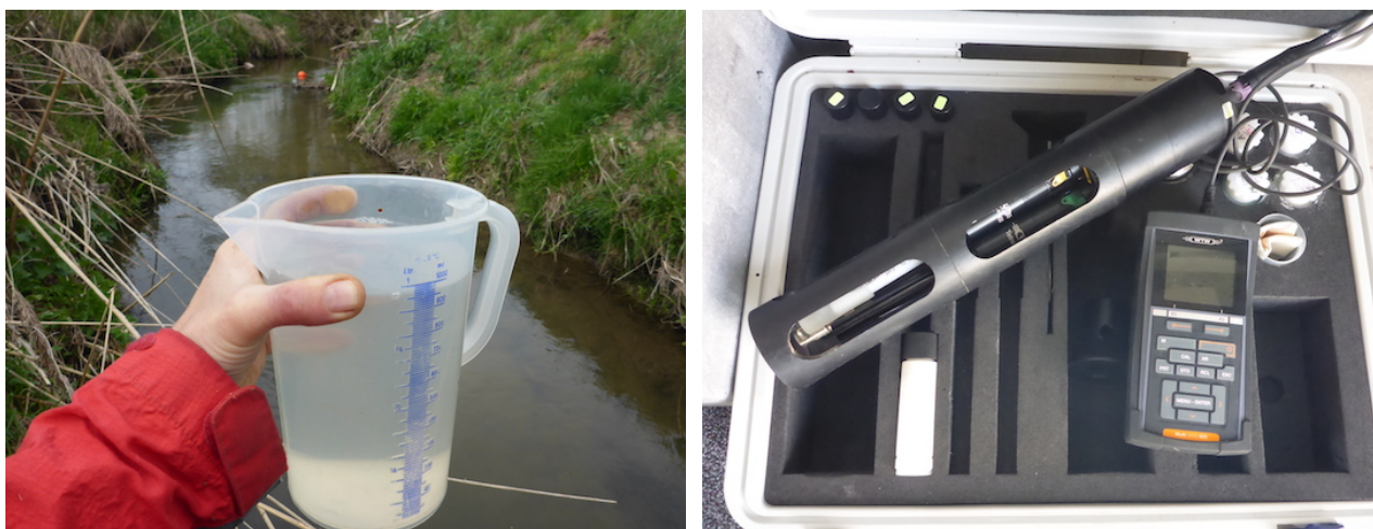
Abb. 8: Schöpfprobe aus der Kleinen Weisach und vorbereitete Multisonde zur Erfassung physikalisch-chemischer Parameter.
