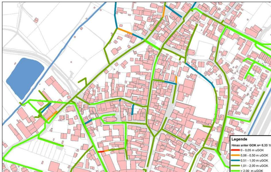
**Bild 5.1:** Planung SRP; berechnete Wasserspiegellagen unter GOK, Modellregengruppe Otter/Königer, Lastfall  $n= 0,33$  1/a
